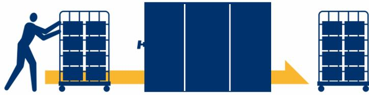
「ウォークスルー型RFIDトンネル式ゲート」は、ハンガーラックやカゴ車もそのまま通せるワイドな間口で、作業性を高めるとともに高精度な一括検品を実現します。
